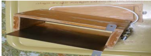
図1. 実験用電極式パン焼きケースの構成。
