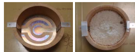
図 9. (左)お櫃型底置き同心円形炊飯器(自作). (右)炊き上がり(23分).
