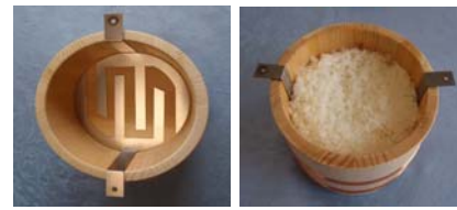
図 8. (左)お櫃型底置き櫛の歯形炊飯器(自作). (右)炊き上がり(33分).
