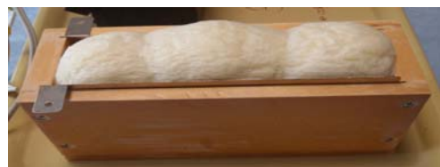
図2. 通電し膨張した生地。
