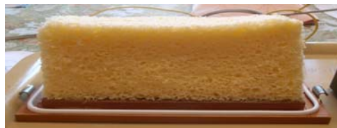
図 1.2. 全卵のホイップ生地に通電した「電極式ケーキ」。
