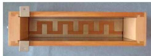
図10. 立て型ケースの底置き櫛の歯形極板(自作). 炊き上がり(20分).
