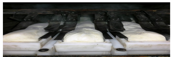
図.10. (上)業務用の電極式パン焼きケース(純チタン板)(下)焼いた電極式パン粉用パン。
