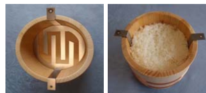
図 17. (左) お櫃型底置き櫛の歯形炊飯器(自作)。(右)炊き上がり(33分)。
