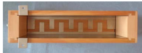
図15. 対向型の底置き櫛の歯形極板（29分）
