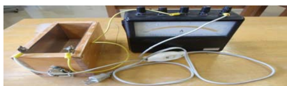
図.1. パン焼き器実験の構成。
