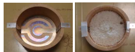
図 18. (左) お櫃型底置き同心円形炊飯器(自作)。(右)炊き上がり(23分)。
