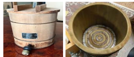
図.13. (左) 厚生式炊飯器(三好日出一氏所蔵), (右) お櫃の底の同心円形極板(1946年4月発売). 2020年7月に平塚市博物館内で同倉庫の別品発見
