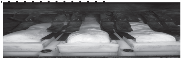
図5. (上) 工場業務用の電極式パン焼きケース（純チタン板）. (下) 焼いた電極式パン粉用パン.
