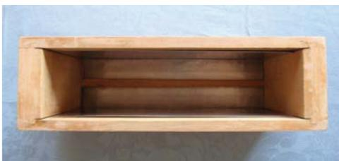
図 11. 極板間隔 1 cm のパン焼き試作器。
