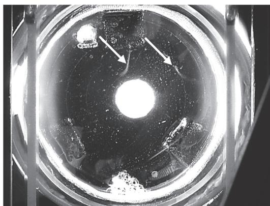
図1. 高温拡散霧箱を用いて観察した放射線の飛跡。中央の白い円形物は1000 G程度の磁石である。
