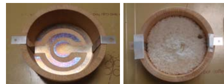
図9. (左)お櫃型底置き同心円形炊飯器(自作の再現厚生式).(右)炊き上がり(20分).
