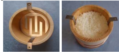
図8. (左)お櫃型底置き櫛の歯形炊飯器(自作の再現タカラオハチ).(右)炊き上がり(25分).
