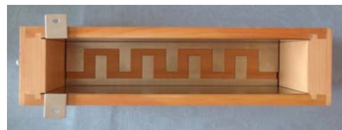
図10. 立て型ケースの底置き櫛の歯形極板(自作).炊き上がり(20分).
