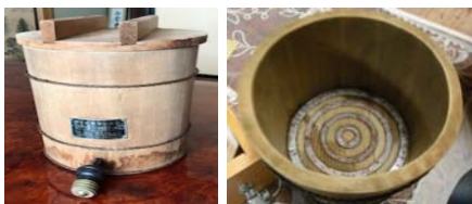
図6. (左)厚生式炊飯器(平塚市博物館所蔵). (右)お櫃の底の同心円形極板(1946年5月発売).
