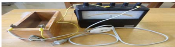
図1. パン焼き器実験の構成.
