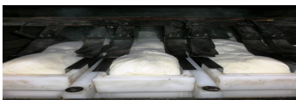
図5。(上)業務用の電極式パン焼きケース(純チタン板50cm × 50cm)。(下)焼いた電極式パン粉用パン。
