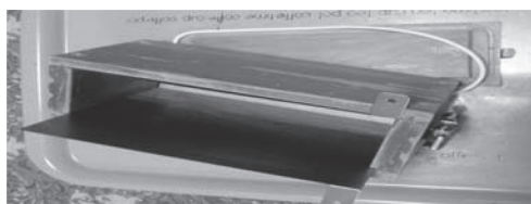
図1. 実験用電極式パン焼きケースの構成.
