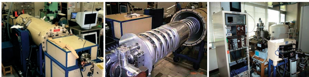
図 4. 左から 1 MeV ペレトロン型加速器の全景, 圧力タンクを外したときに見える加速管とコラム, 測定系および照射系。
